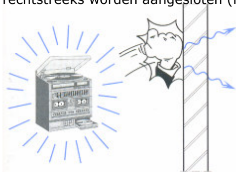
Figuur 10.26 Luchtgeluid brengt een constructie aan het trillen waardoor deze ook aan de andere kant geluid afgeeft: een constructie kan ook mechanisch in trilling worden gebracht en daardoor geluid gaan afstralen (contactgeluid)
