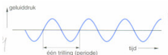
figuur 10.4 Verloop van de geluiddruk als functie van de tijd bij een zuivere toon
